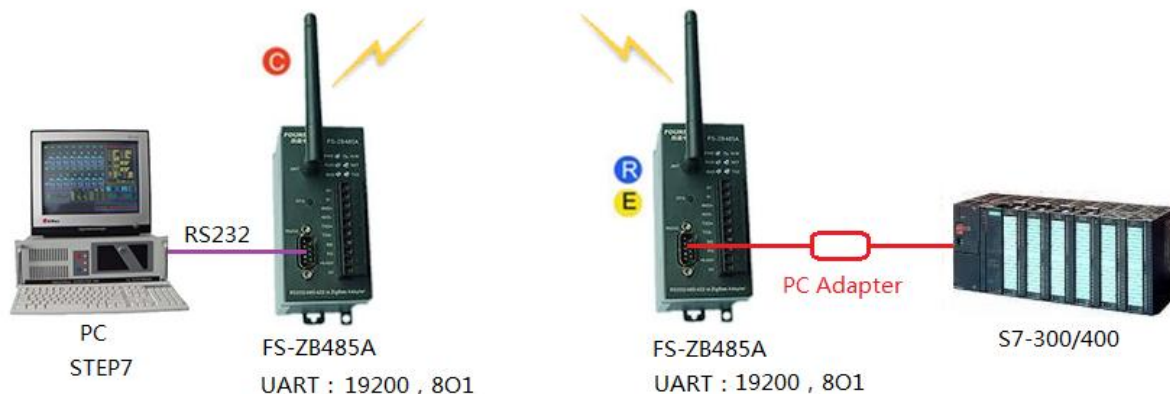
图 2-1 用 FS-ZB485A 实现电脑与 S7-300/400PLC 的 MPI/DP 口无线通信
