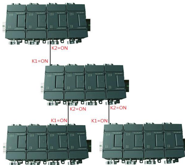
图 6-4 FS-LON-RPT 集线器的级联
